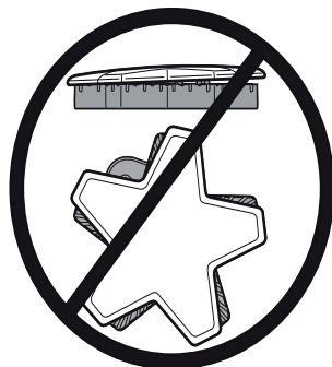
Incorrecto de la tapa del quemador
