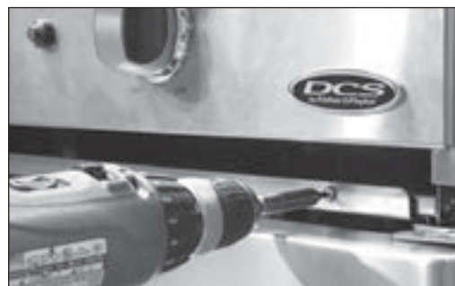
FIG.13 Fixez le gril à la partie avant du chariot à l'aide de vis phillips (fournies).
