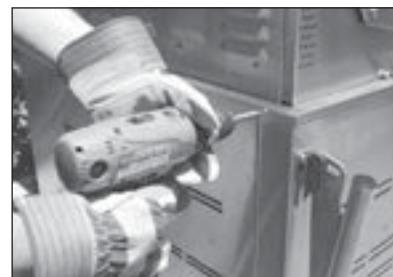
FIG.12 Fixez le gril à la partie arrière du chariot à l'aide de (2) vis phillips fournies (10-24 x 1/2 po).
