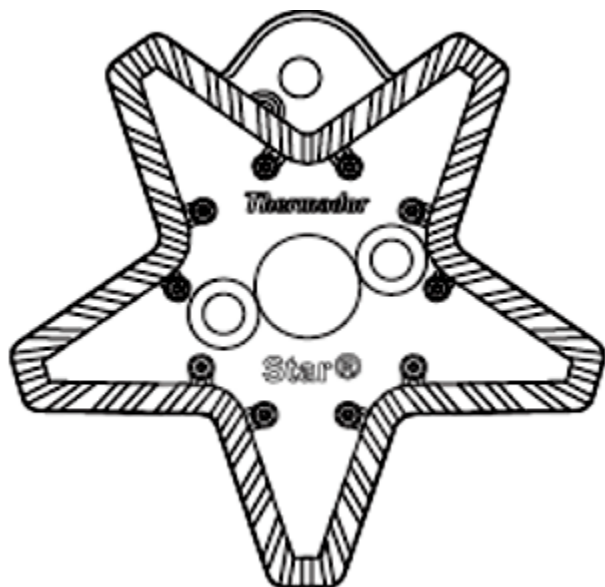
Figura 8: Base del quemador Star® de latón
