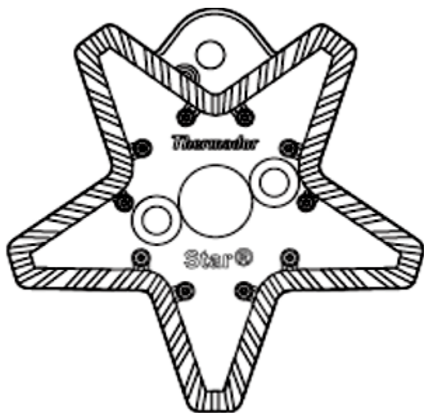
Figure 8 : Base de brûleur Star mc en laiton
