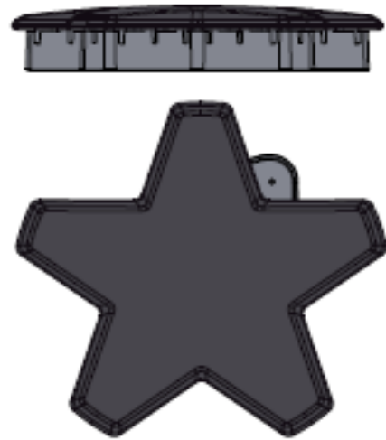
Figure 14 : Chapeau de brûleur correctement placé
