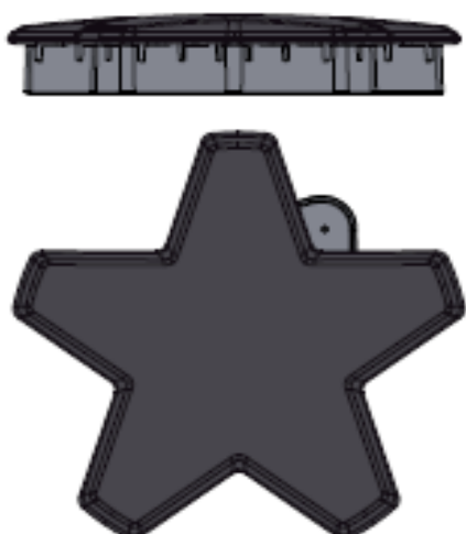
Figura 14: Tapa de quemador colocado correctamente
