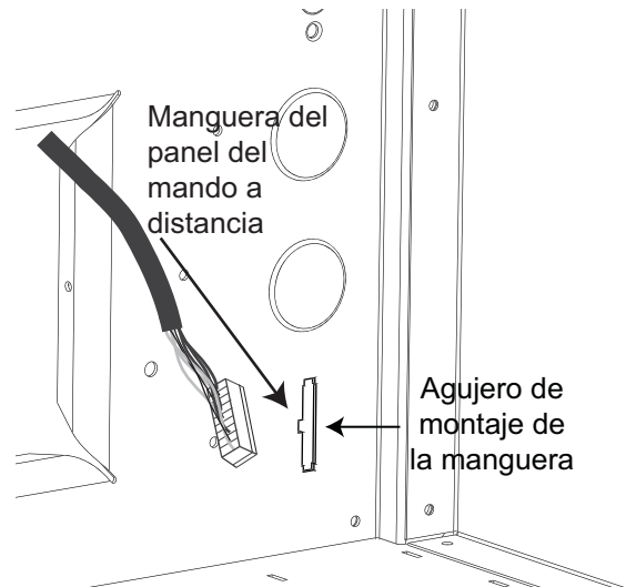
Figura 14: Agujero de montaje de la manguera del mando a distancia
