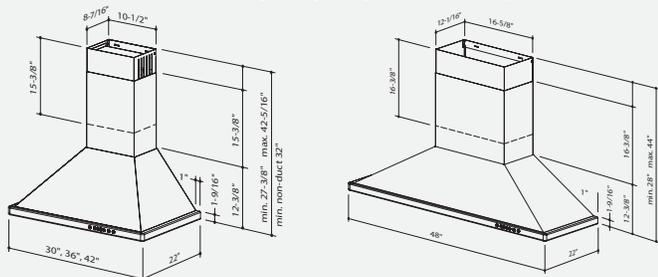
Installation en recirculation sans conduit possible au moyen de la cheminée télescopique réversible
